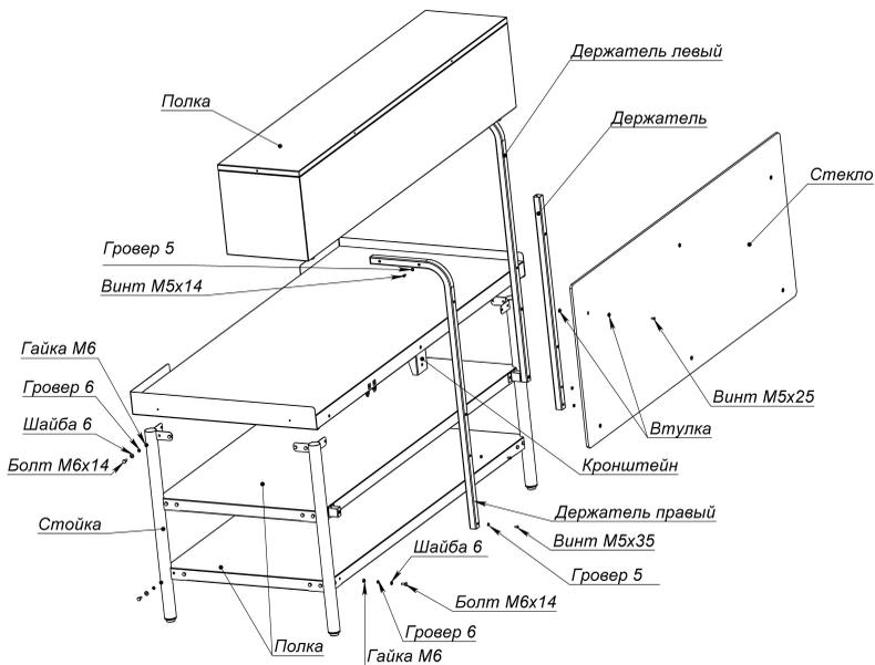
4.6. Собранный стол установить на пол. Закрепить держатели к задней части стола в следующей последовательности :
