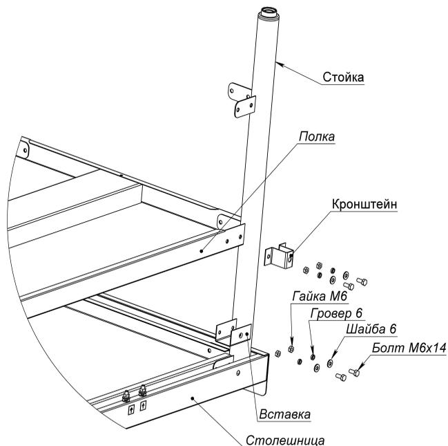
4.2. В передние углы столешницы вставить стойки и закрепить их при помощи болтовых соединений М6 (Болт М6, шайба 6, гровер 6, гайка М6). Установить стойки в заднюю часть столешницы, вставить вставки между бортом столешницы и стойкой и закрепить болтовым соединением М6. Крепеж не затягивать.
