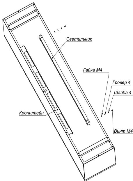
Светильник крепить к кронштейну при помощи винтового соединения М4 (Винт М4, шайба 4, гровер 4, гайка М4). Установить полку на держатели закрепив ее винтами М5 с гровером 5.
