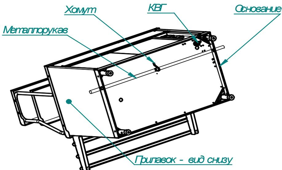
В основаниях изделий линии раздачи введено сквозное отверстие диаметром 29,5 мм и поддерживающие хомуты для возможности и проведения металлорукава с питающими кабелями сквозь все изделия линии раздачи.
