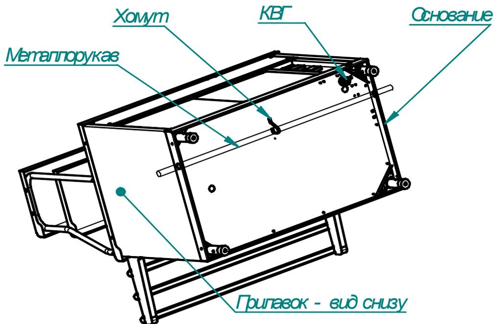
В основаниях изделий линии раздачи введено сквозное отверстие диаметром 29,5 мм и поддерживающие хомуты для возможности и проведения металлорукава с питающими кабелями сквозь все изделия линии раздачи.
